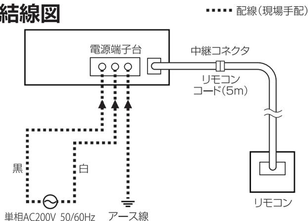
(注) ブレーカーを入れる前に必ず指定電圧「AC200V」が接続
