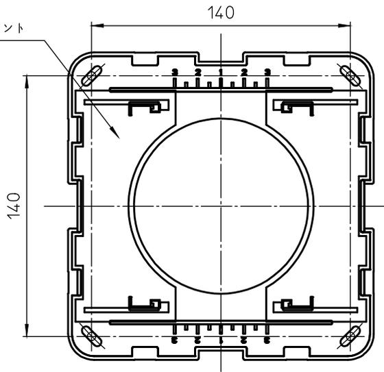
副吸込みジョイント取付寸法図
