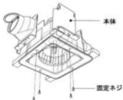
⑤排気側・副吸込口側のダクト接続口を仮固定しているトラス頭タッピングネジ各2本を確実に締付けます。
