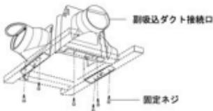
③排気側・副吸込口側を間違えないよう本体のスライド部をダクト接続口の両端に合わせ本体を野縁に差込みます。ダクト接続口の引掛部に当るまで本体を押し上げます。
