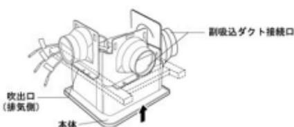
④本体がダクト接続口に密着していることを確認してから、付属のトラス頭タッピングネジ4本で本体をすき間のないようしっかりと固定してください。(すき間がありますと風漏れの原因になります。)
