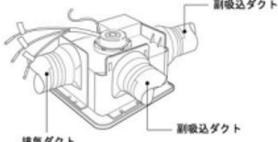
①副吸込ダクト接続口を上へ引抜いて外します。
