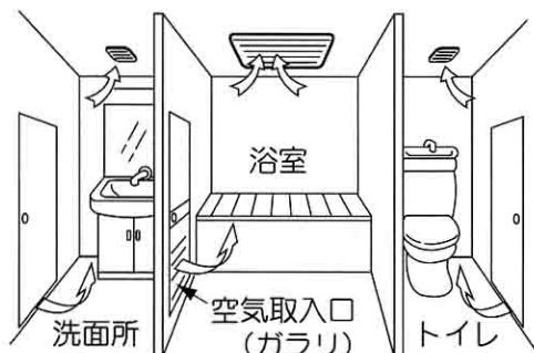
浴室・洗面所・トイレの3ヶ所より、室内の汚れた空気を24時間排出し、室内を快適に保ちます。
