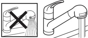
シャワーのまま使用したり、流水の真下に物などがあると、ディスポーザーに十分な水が供給されず、破砕処理が正常にできず、本体内部の部品がはやく磨耗する原因になります。また、排水管に流れきれないゴミが堆積し、排水管が詰る原因になります。
