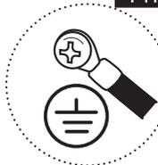
故障や漏電のときに感電する恐れがあります。アース線の取り付けは、法律で義務付けられています。
