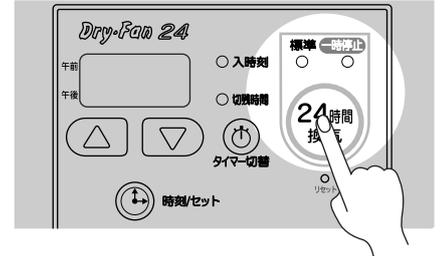
※一時停止に切り替わってから1時間経過すると、自動で標準ランプが点灯し、24時間換気運転に戻ります。
