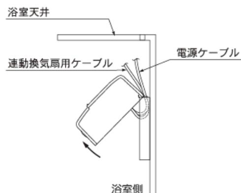
2. 取付板のツメ部が確実に引っ掛かっていることを確認して、本体固定ねじ(2本)を締め付ける。
