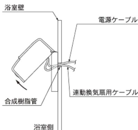
2. 合成樹脂管の浴室側および外壁側を湿気やスキマ風などがもれないよう、パテなどで埋めます。
