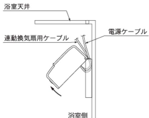
2. 取付板のツメ部が確実に引っ掛かっていることを確認して、本体固定ねじ(2本)を締め付ける。
