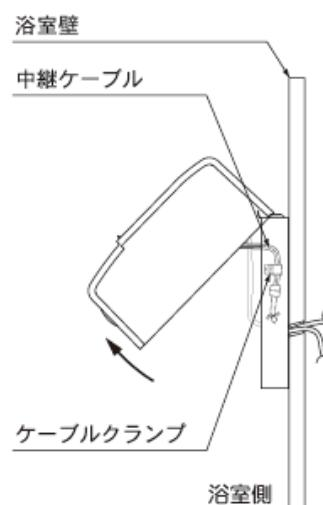
④取付板のツメ部が確実に引っ掛かっていることを確認して、本体固定ねじ(2本)を締め付ける。
