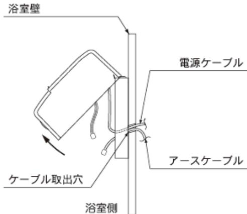
※壁にケーブル取出穴をあけた場合は、合成樹脂管の浴室側および外壁側を湿気やスキマ風などがもれないよう、パテなどで埋めます。
