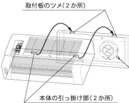
木枠の補強材の場合、この穴に電源ケーブル、連動換気扇のアースケーブルを通してください。
