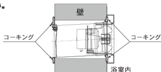
**連動換気扇を連動換気扇取付用ねじ4本で取り付けてください。**
