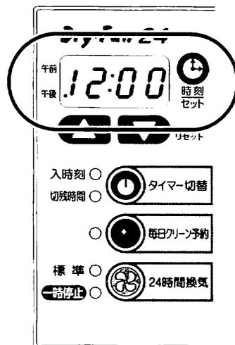
※ブレーカーを入れたとき、リセットボタンを押したとき、必ず時刻設定をしてください。設定しないと、入時刻機能および毎日クリーン換気が使えません。(タイマー切替ボタンを押しても、入時刻に切替わりません)
