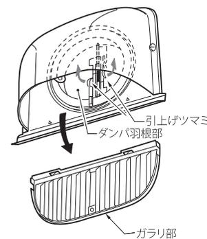
②溶飛したヒューズを取り除き防火ダンパ羽根部についているつまみ部を引き上げダンパ羽根部を引き起こします。
