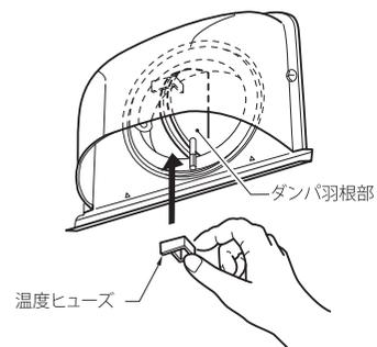
③新しい温度ヒューズのダンパ羽根部の凹部に温度ヒューズの凸部がはまる様に確実に取り付けます。
