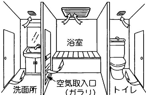
浴室・洗面所・トイレの3ヶ所より、室内の汚れた空気を24時間排出し、室内を快適に保ちます。
