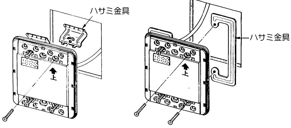
⑤付属の4×35皿タッピンねじ4本でリモコン本体を壁に取り付けてください。
