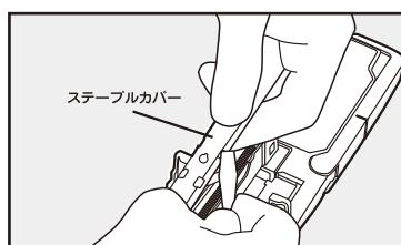
ステープルカバー両側側面の黒いプラスチックを先のとがったもので押し込みステープルカバーをはずす。
