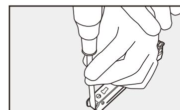
マガジンを上下逆に置いて押さえ、後部に出ている黒いプラスチック(バネガイド)をマイナスドライバで下に押してはずす。ドライバをたたくようにすると楽にはずせる。
