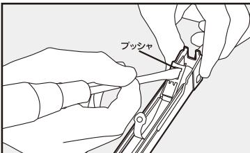
図の位置でプッシャ先端を持ち上げると、マガジンからはずれる。
