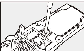
プラスドライバで本体中央のネジをはずして、クリンチャを取りる。
