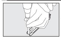
マガジンを上下逆に置い て押さえ、後部に出ている 黒いプラスチック(バネガ イド) をマイナスドライバ で下に押してはずす。ドラ イバをたたくようにすると 楽にはずせる。
