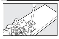
プラスドライバで本体 中央のネジをはずして、 クリンチャを取る。
