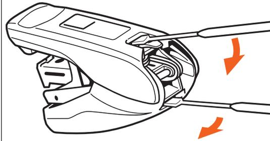
本体をさかさまにし、図の2箇所のプラスチックカバーと金属ボディの隙間にマイナスドライバーを入れ、矢印の方向に下げるとはずれます。
