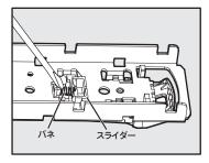
クラッチスイッチ(黒いプラスチックパーツ)をはずし(持ち上げるとはずれる)、 裏返した板金の内側から クリンチャガイドとスライ ダの間のバネをはずす。
