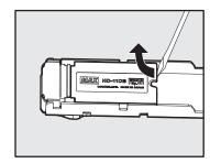
クリンチャカバー(白いプラスチックパーツ)の後ろからマイナスドライバを差し込み、テコの原理でクリンチャカバーをはずす。外したクリンチャカボーの内側にあるバネをはずす。
