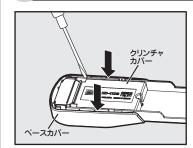
ドライバをベースカバーの 隙間から差し込み左右に 広げてはずす。
