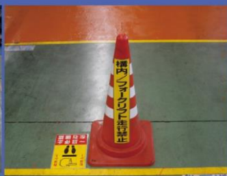
人と輸送機の交差点所に「一旦停止」を表示。床は人の通路を青、リフトが通る場所をオレンジに塗り分ける。
