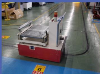
人と輸送機の交差点所に「一旦停止」を表示。床は人の通路を青、リフトが通る場所をオレンジに塗り分ける。
