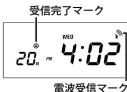
電波受信マークが表示されていれば、その設置場所で標準電波を受信できます。タイムレコーダの時計が自動的に補正されます。
