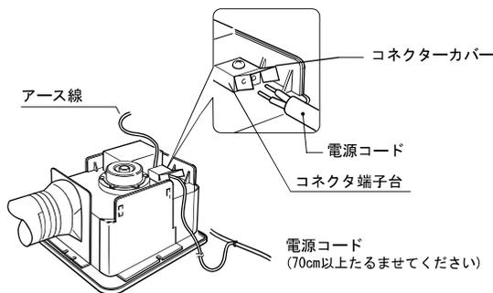
**警告** D種接地工事によるアース線を確実に接続してください。
