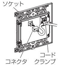
7. リモコン本体をスイッチボックスに付属のねじ4本でスイッチボックスに取付けてください。
