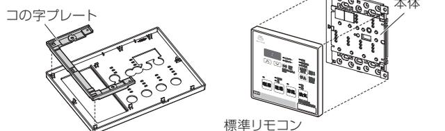
4. コの字プレートを、コの字プレートに取付いているねじ2本で浴室照明スイッチに取付けてください。
