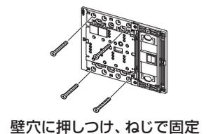
7. リモコンカバー、プレートを取付けてください。
