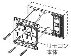
8. リモコンカバー、プレートを取付けてください。
