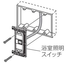
6. リモコン本体裏のソケット (3P) にリモコンコード先端のコネクタを確実に差し込み、コードクランプで固定してください。コネクタが確実に接続されていることを確認してください。差し込みが不完全な場合、故障や誤動作するおそれがあります。
