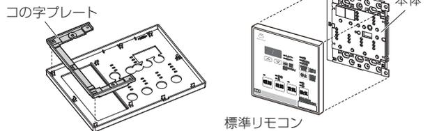
4. コの字プレートを、コの字プレートに取付いているねじ2本で浴室照明スイッチに取付けてください。
