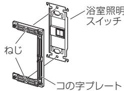
5. 浴室照明スイッチを、付属のねじ2本でスイッチボックスに取付けてください。
