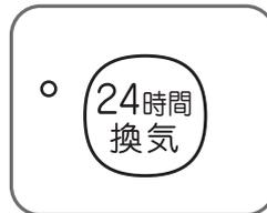
※「暖房」「乾燥」「涼風」「換気」運転をしているときは、24時間換気ボタンは操作できません。停止ボタンを押し、運転を停止させてから行ってください。
