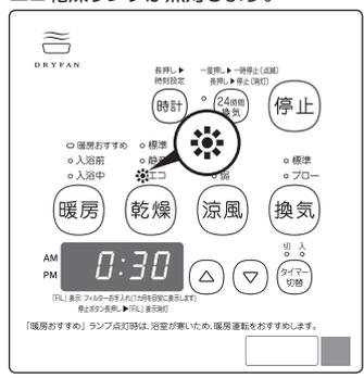
※エコ乾燥運転中も 24 時間換気運転は継続されます。(24 時間換気ランプは点灯しています)
