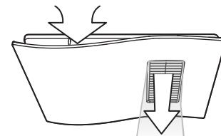
標準換気よりも換気量を増やし、浴室内の空気を循環させながら換気します
