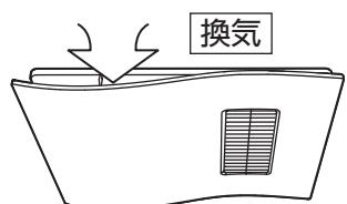
停止後、24時間換気ランプが点灯している場合は、24時間換気運転に切り替わります。
