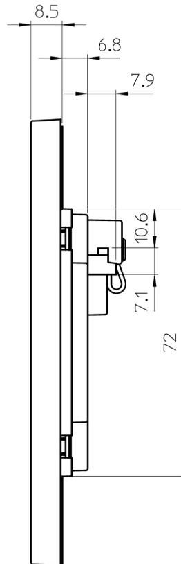
リモコン取付け寸法図
