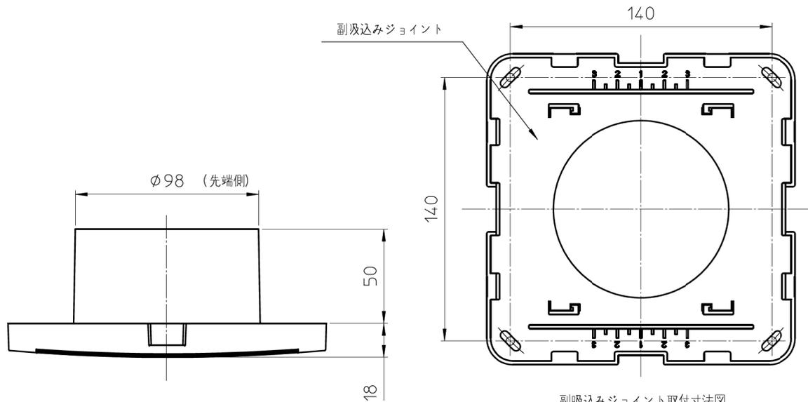
副吸込みジョイント取付寸法図
