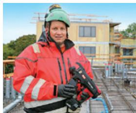
当社は、1993年に世界初の充電式鉄筋結束機を発売し、鉄筋結束作業の生産性向上を図ってきました。
