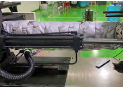
成形機加熱部に断熱材を巻き付け
