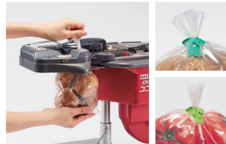
包装作業の効率化を実現する青果・食品用袋口結束機「コニクリッパ」と簡単開封が可能な専用結束具「コニクリップ」2022年には、環境に配慮したバイオマス素材を配合した『バイオマス コニクリップ』を発売。
