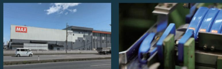
倉賀野工場では、小型ホッチキスとエアコンプレッサのタンクを生産しています。自社開発の製造設備により、プレス加工から組立までの一貫工程を自動化、インライン自動検査などオートメーション化されたラインにより、高品質・高効率の量産体制を構築しています。
