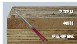
今回当社では、長さ50mmの4MAフロアステープルが打てる常圧釘打機を開発。負荷の高い部材の組み合わせでも確かな打ち込みを実現するため、エンジン部を強化するとともに、ステープルの直進性を高める“座屈低減機構”を搭載しました。
