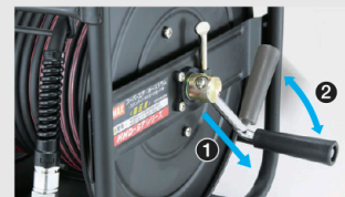
ハンドル取っ手を引いてから、巻き取り用 ドラム側に倒して収納します。(スタンダードモデル)
