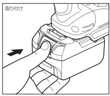
電池パックを本機から取外すときは、正面に あるストッパを押し下げ、矢印方向にまっすぐ 電池パックをスライドして取り外してください。
