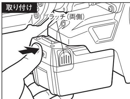
電池パックを本機から取り外すときは、①電池パックを本体側に少し押し込んでから、②左右両側にあるラッチを押して、矢印方向にまっすぐ電池パックをスライドして取り外してください。
