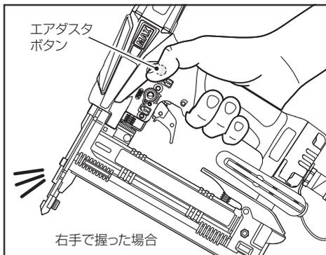
※HA-38F4 (D) のエアダスタには風量調整機能がついています。エアダスタボタンの押し加減でお好みの風量に調整して使用してください。
