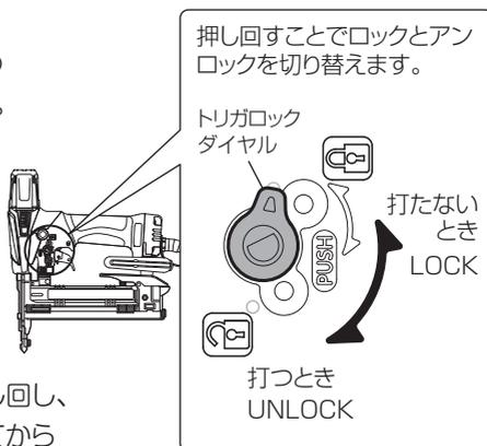
作業を行う際はトリガロックダイヤルを押し回し、UNLOCK（アンロック）の位置にセットしてから作業を開始してください。
