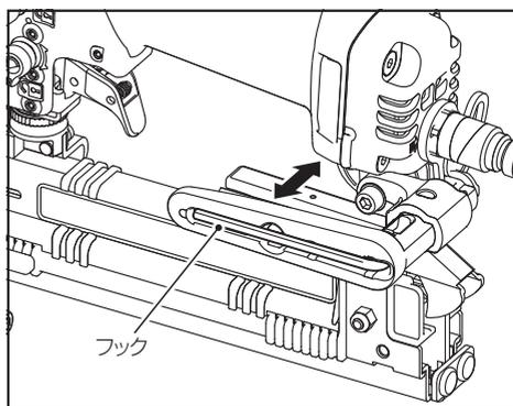
フックは反対側に取り付けることができます。付け変えるときは、六角棒スパナでボルトをはずし、フックの取付け位置を変えてから、再び組込んでください。
