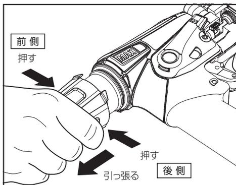
取れない場合は、図の位置にマイナスドライバを差し込み、シリンダキャッププロテクタを浮かせた状態で引っ張ってください。
