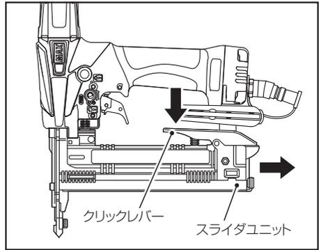
使用前に安全装置が完全に作動するか必ず確認する。
