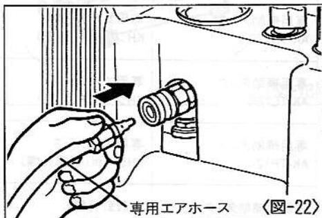
〈本機の専用エアチャック(減圧弁H後)を使用する場合〉
